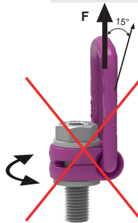
Bild 3: Verbotene Drehbewegung bei Belastung in Achsrichtung
