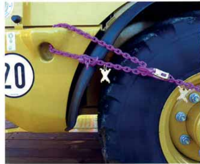
Kranzkette als Lösung bei maßlich unpassenden Zurrpunkten.
