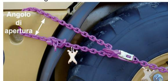
Fig. 13: esempio di utilizzo della catena ad anello chiuso
