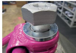
Abb. 9: Sprengring umlaufend vertieft in der Ansenkung positioniert
