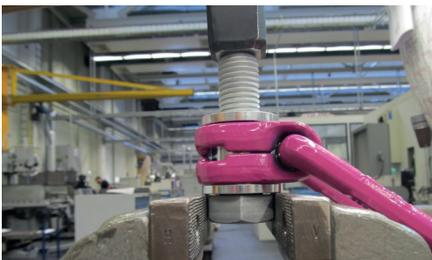
Abb. 7: Auflage des VLBG-PLUS zur Demontage der Schraube
