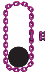
Abb. 1: Kette nicht verdreht und Verwendung im freien Kettenstrang
