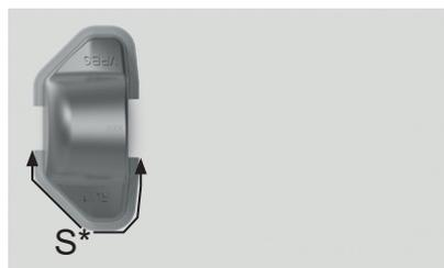
Abb. 1: Anschweißklotz 1 anschweißen
